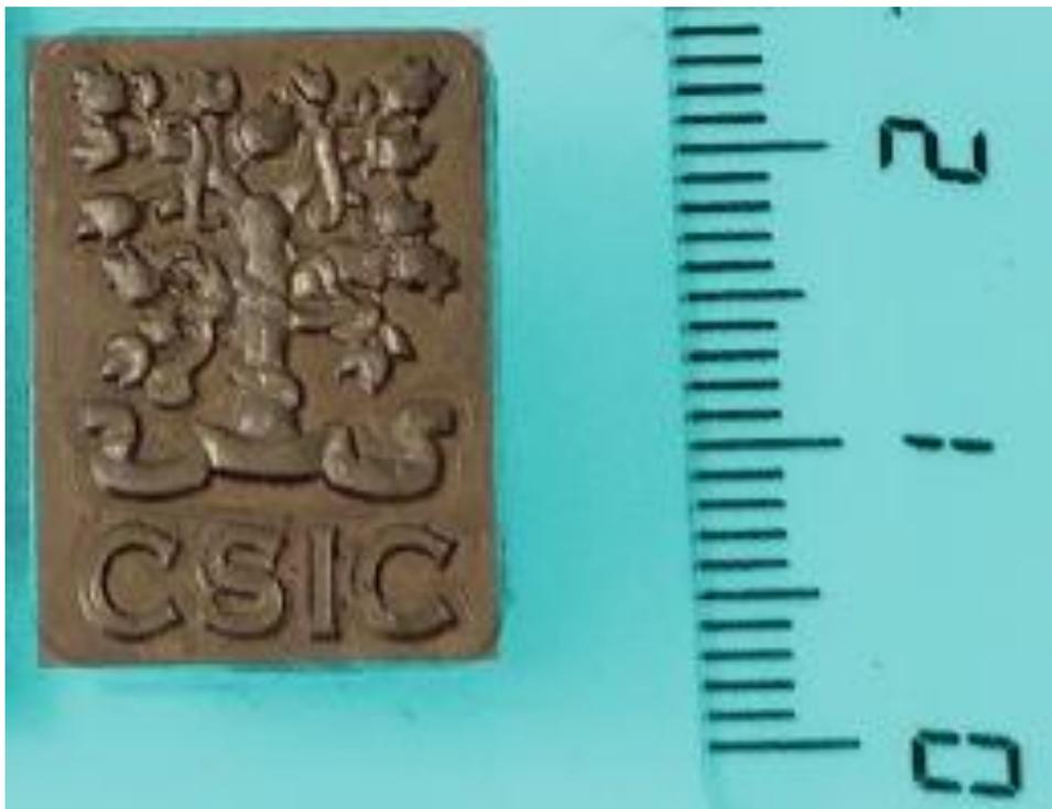
*Imagen del logotipo del CSIC fabricado mediante el microfresado en una aleación  $W_{78}Cu_{22}$  utilizando la metodología propuesta./ (CSIC)*
