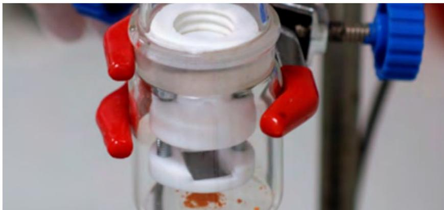
**Nuevo dispositivo de sublimación por vacío. El dispositivo permite depositar el material de interés directamente en la superficie en la que se desea trabajar sin necesidad de depositar en superficies receptoras intermedias o el uso de disolventes u otras sustancias intermedias para su depósito.**
