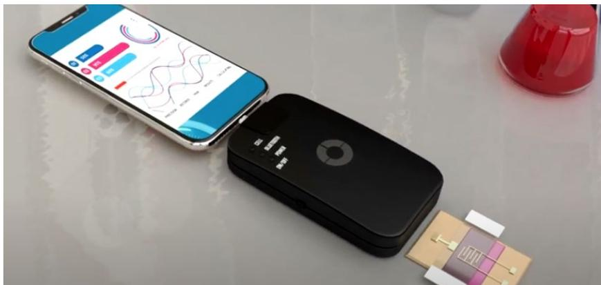
**Dispositivo de diagnóstico portátil para la detección de analitos en muestras biológicas. El biosensor permite una detección cuantitativa sin necesidad de utilizar marcadores. Su utilización es simple y no necesita personal cualificado.**
