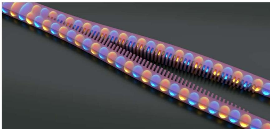
**Divisor de potencia de banda ultra-ancha para circuitos fotónicos integrados con dos configuraciones de operación diferentes: multimodo y monomodo**
