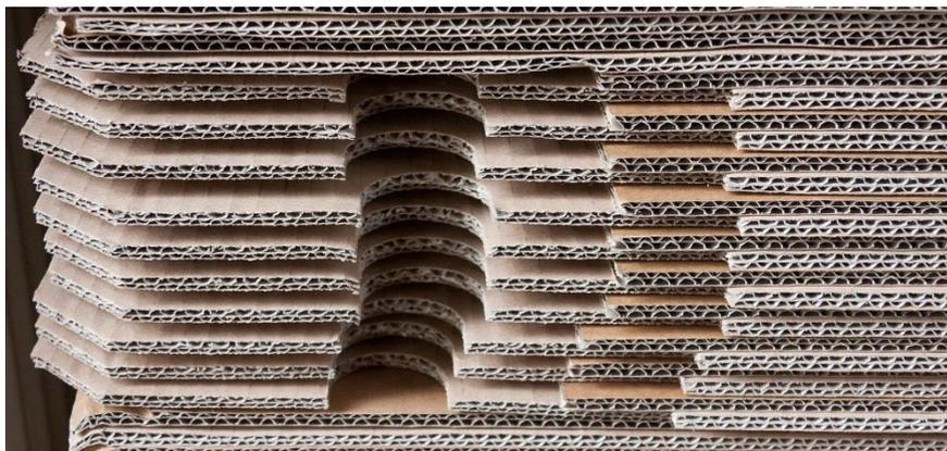
**Papel de embalaje reforzado con un sorprendente aumento de la resistencia a la compresión y la rigidez, por aplicación de un bio-producto obtenido de residuos ligno-celulósicos sin necesidad de añadir fibras vírgenes celulósicas, aditivos de resistencia o someter al papel a etapas adicionales de manipulado.**
